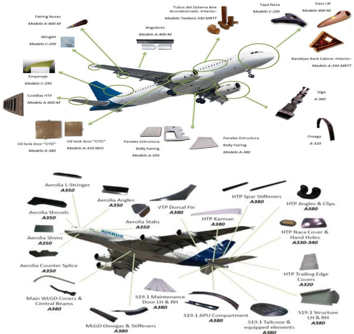
La fabricación de estas piezas se produce en la planta de Jerez de la Frontera (Cádiz). Adicionalmente a la fabricación de piezas y estructuras para el sector aeronáutico, durante 2017, Airtificial firmó un acuerdo de proveedor estratégico con Hyperloop Transportation Technologies, Inc. para desarrollar y fabricar, en exclusiva, las cápsulas del nuevo medio de transporte impulsado por dicha compañía. El 2 de octubre de 2018 fue presentada la primera cápsula en El Puerto de Santa María (Cádiz).
